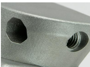
Fig. 5.5.2 pieza con cavidades internas fabricada mediante SLS
