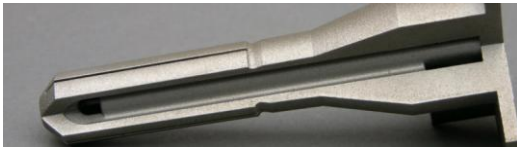
Fig. 5.5.1 pieza con cavidades internas fabricada mediante SLS
