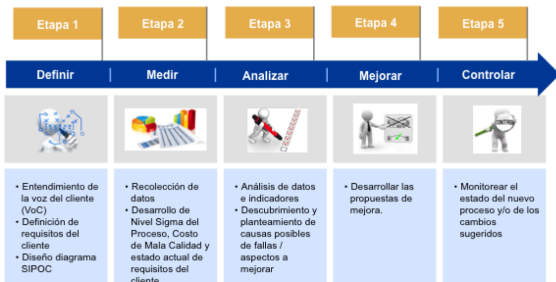
Figura 3.9: Etapas de implementación de Six Sigma en proceso de Despacho de Ambulancias (Fuente propia)
