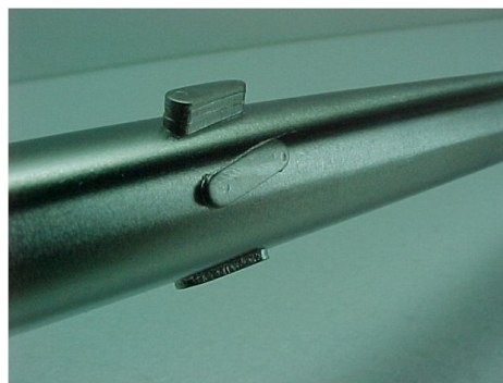
Imagen 8: Espaciadores soldados a las barras combustibles
