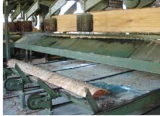
Foto N°6 y N°7: Luego del corte se separan los costaneros
