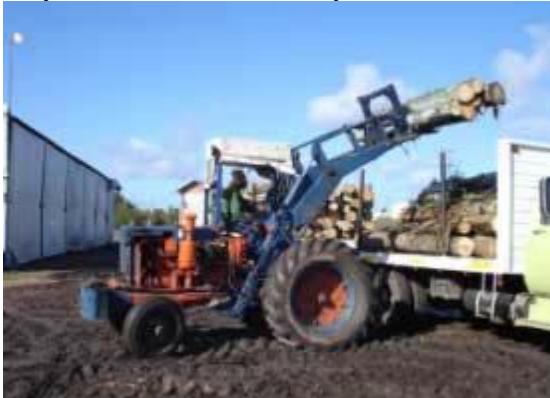
Foto N° 1: Descarga de troncos con tractor con uñas - Foto N°2 Tractor de Uñas
