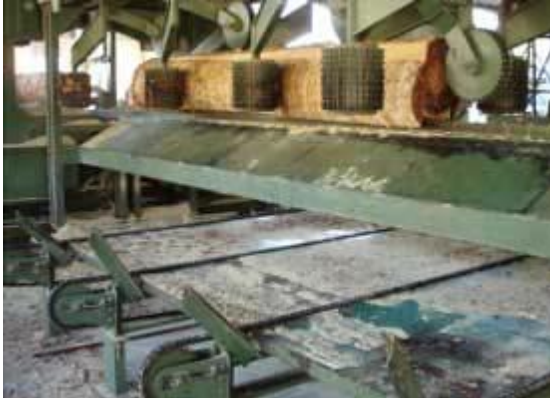
Foto N°6 y N°7: Luego del corte se separan los costaneros
