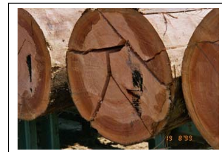
Este rollo presenta rajaduras cruzadas
