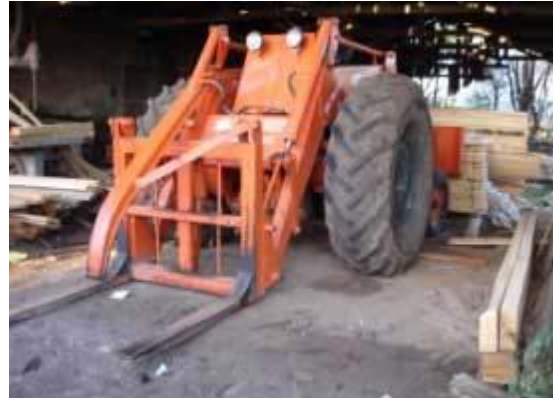
Foto N° 1: Descarga de troncos con tractor con uñas - Foto N°2 Tractor de Uñas
