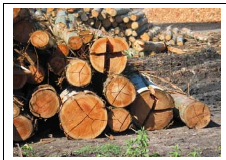
Esta fotografía muestra estrellado severo
