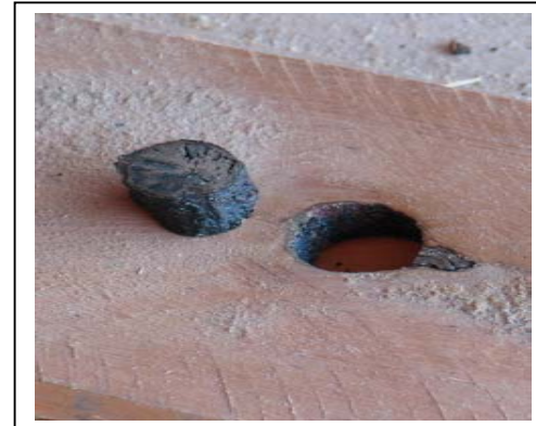
El trozo de madera muerta (aquí recubierto por quino) se ha desprendido, creando un agujero en la tabla
