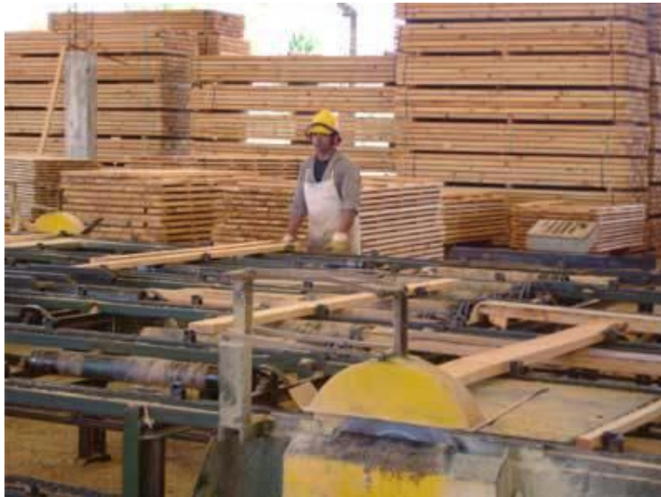
Foto N°9 Despuntado de sierra circular
