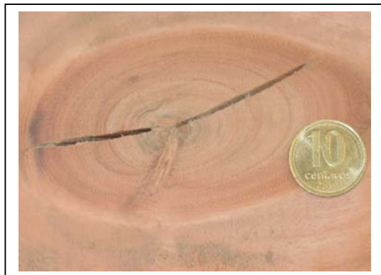
Nudo firme exhibiendo una grieta
