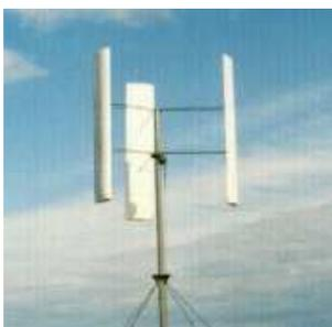
**Aerogenerador con rotor Giromill:** Este tipo de generadores también fueron patentados por G.J.M. Darrieus. Consisten en palas verticales unidas al eje por unos brazos horizontales, que pueden salir por los extremos del aspa e incluso desde su parte central. Las palas verticales cambian su orientación a medida que se produce el giro del rotor para un mayor aprovechamiento de la fuerza del viento.
