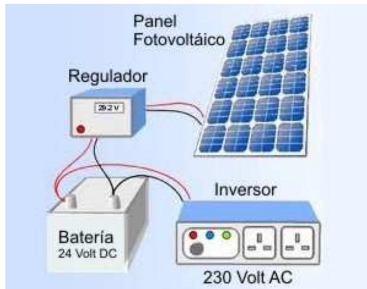
*Esquema básico de una instalación de Energía Solar Fotovoltaica.*
