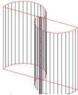
**Aerogenerador con rotor Savonius:** Es el modelo más simple de rotor, consiste en cilindros huecos desplazados respecto su eje, de forma que ofrecen la parte cóncava al empuje del viento, ofreciendo su parte convexa una menor resistencia al giro. Se suele mejorar su diseño dejando un espacio entre ambas caras para evitar la sobre presión en el interior de la parte cóncava. Pueden construirse superponiendo varios elementos sobre el eje de giro.
