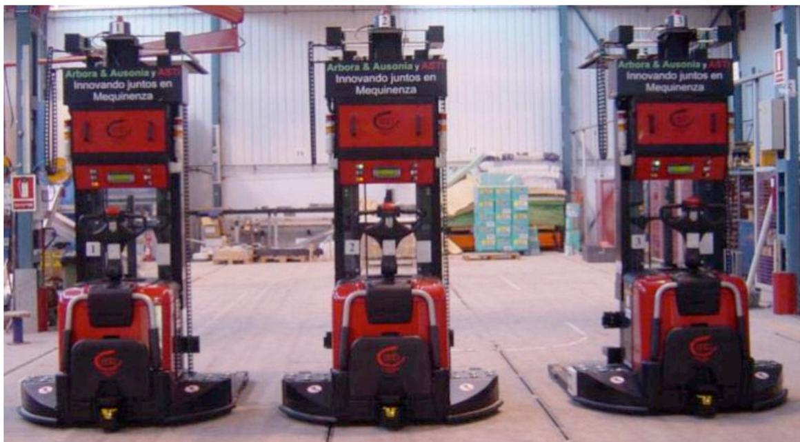
Figura 12: Vehículos de guiado automático con sistema magnético.
