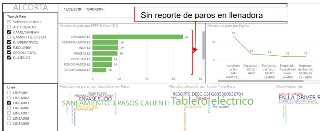
Figura 36 Tablero de comando sobre paros de equipos en línea 3 13/03/2019
