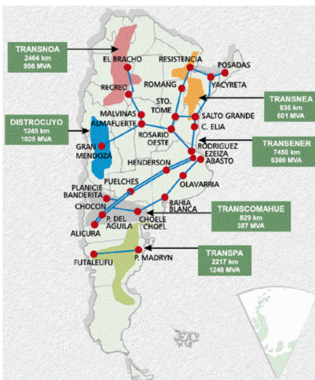
Figura 41: Sistema de distribución troncal
