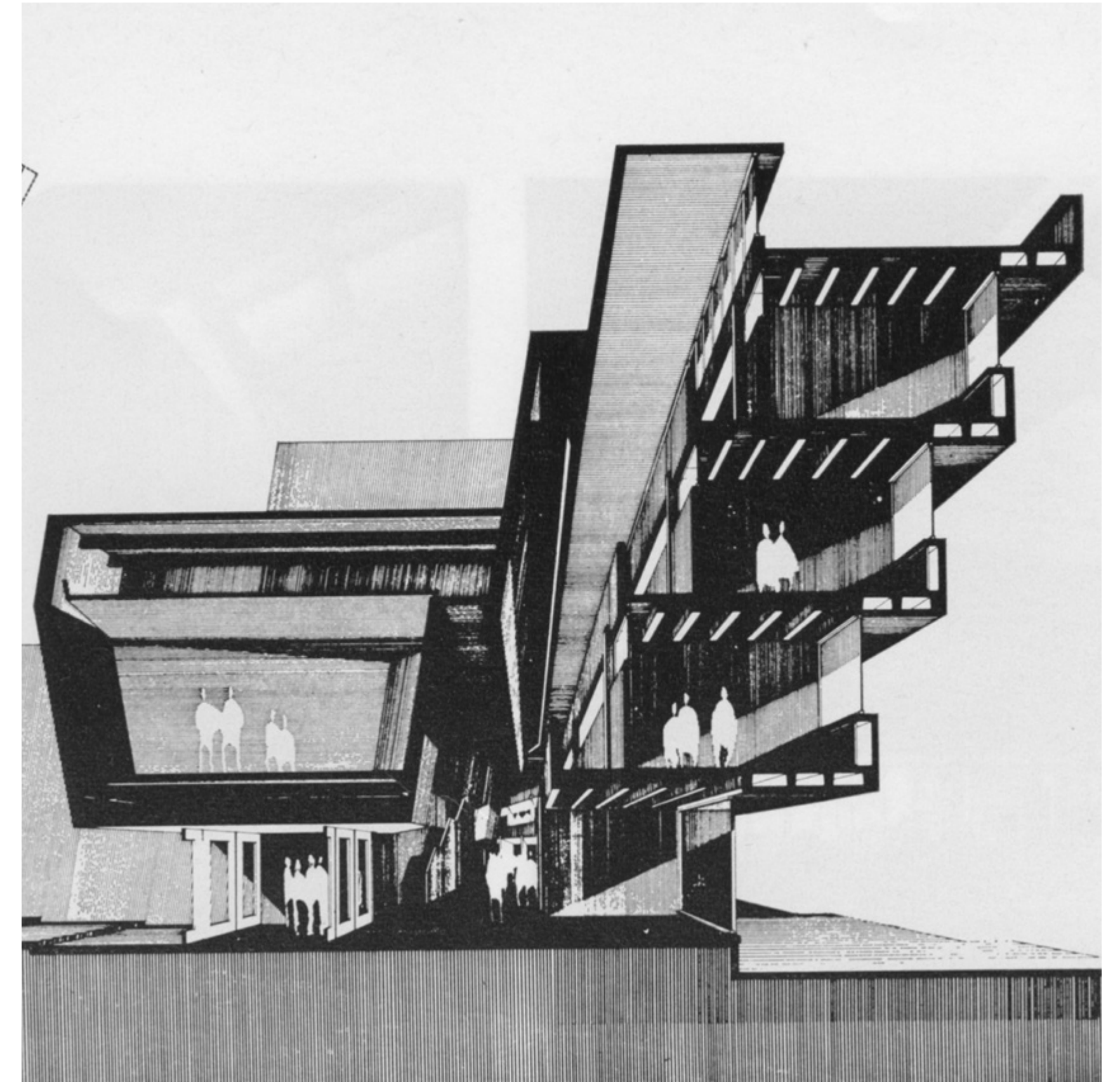
Sección perspectivada. Introducción al modelo de utópico. Edificio de masas expansivas. Scarborough Collegue, John Andrews. Toronto, Canadá, 1964. Ala Sur. Se detectan las distorsiones producidas en el interior debido al defasaje de la masa, la circulación sufre un desplazamiento en cada uno de los niveles. Esto genera dobles alturas y planos inclinados que tensionan la relación entre la superficie circulable y la programable.
