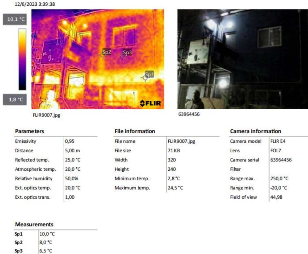
Figura 21. Termografía y cuadro de datos resumen. Fuente: (Banco Mundial/SEG Ingeniería, 2024).
