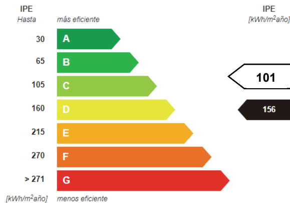
Figura 44. Variación de la etiqueta de kWh/m 2 /año de la vivienda con mejoras. Fuente: Aplicativo PRONEV .
