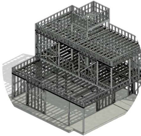
Figura 12. Casa steel frame. Fuente: página web MasHouse
