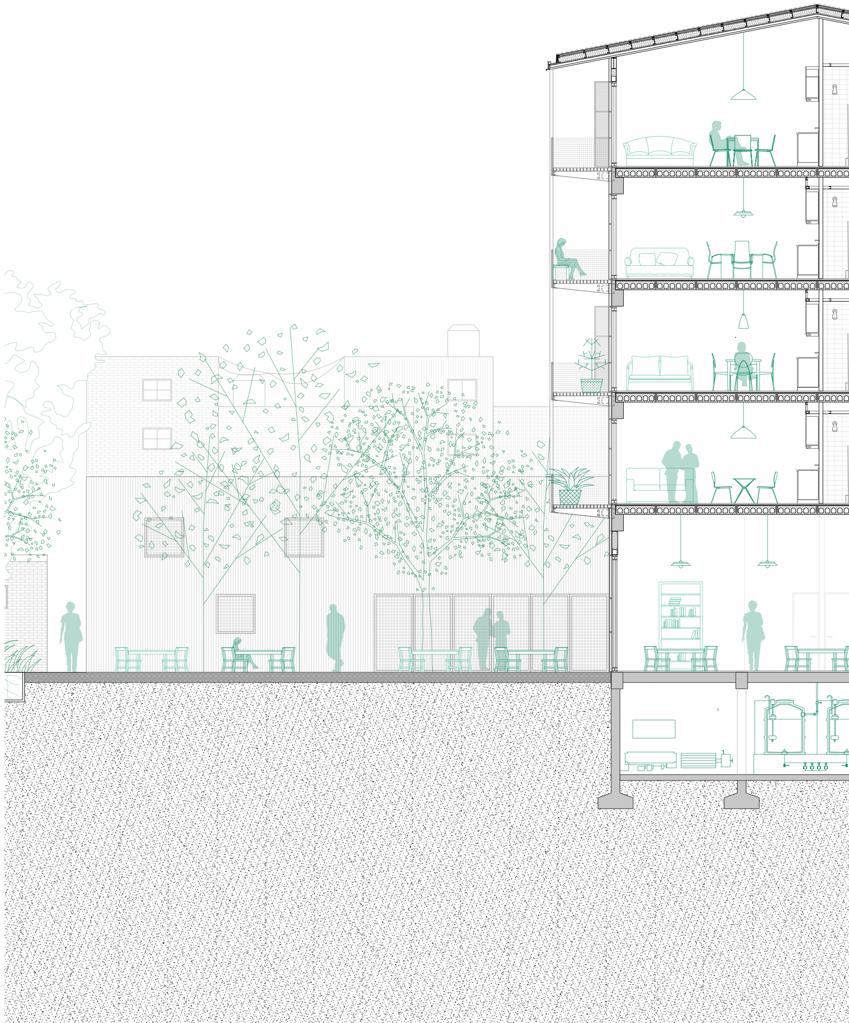
Imagen 60: Corte técnico transversal que detalla la organización vertical del programa: subsuelo de servicios, planta baja híbrida de doble altura y niveles residenciales con sistemas de control solar. Miranda Baltuliones, Detalle de organización programática y técnica. Variable (Digital). Fuente: Miranda Baltuliones, 2026.
