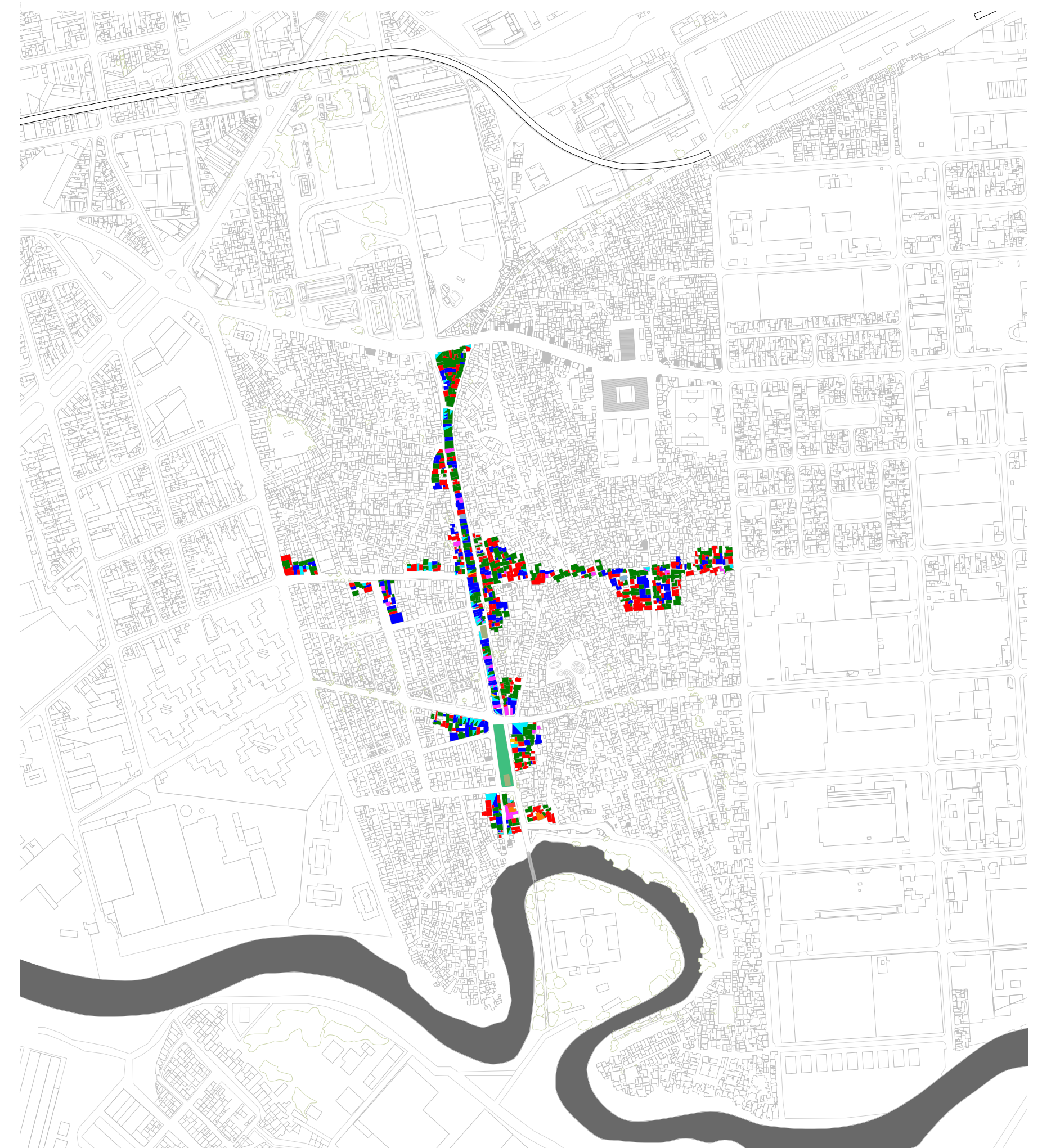
Imagen 29: Relevamiento detallado y conteo de las viviendas, comercios e instituciones que deben ser removidos para permitir la apertura de los nuevos ejes de circulación y la perforación del tejido. Guadalupe Perea, Miranda Baltuliones y Lara Tarlowski, La perforación del tejido como operación fundante - Conteo de afectaciones. Variable (Digital). Fuente: Guadalupe Perea, Miranda Baltuliones y Lara Tarlowski, 2025.
