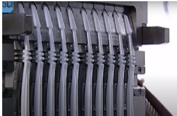
Imagen 15– Cuerpos de cepillos dentales dentro de la matriz de inyección
