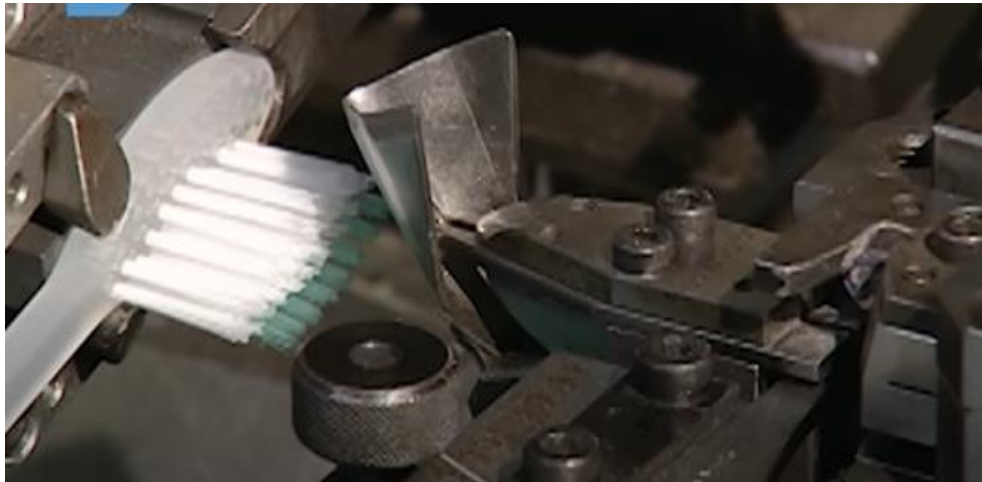
Imagen 18– Detalle de proceso de implantación de filamentos
