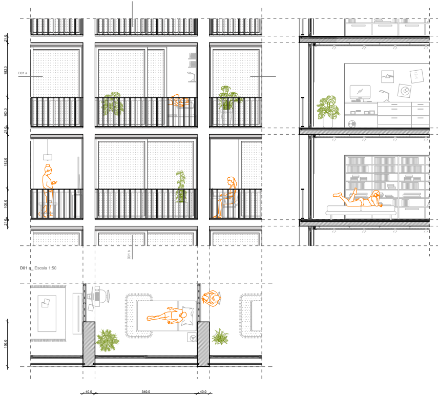
PROPUESTA FACHADA SUR Y ESTE Detalle 01_Escala 1:50
