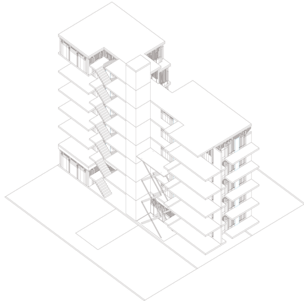
Axonometría. Escala 1:250. Frente y núcleo. En primer plano el núcleo, en el que se presenta un elevador montacargas que permite, entre otras cosas, el estacionamiento de autos hacia el frente
