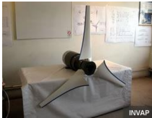
Prototipo de hélice del INVAP para el desarrollo de turbinas hidrocínéticas.
