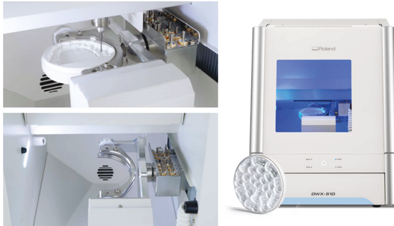
Figura 15. Fresadora de 5 ejes marca Roland, Modelo DWX – 51D. Se puede notar que en este tipo de fresadoras es posible trabajar con discos para obtener estructuras complejas como puentes, barras para implantes.
