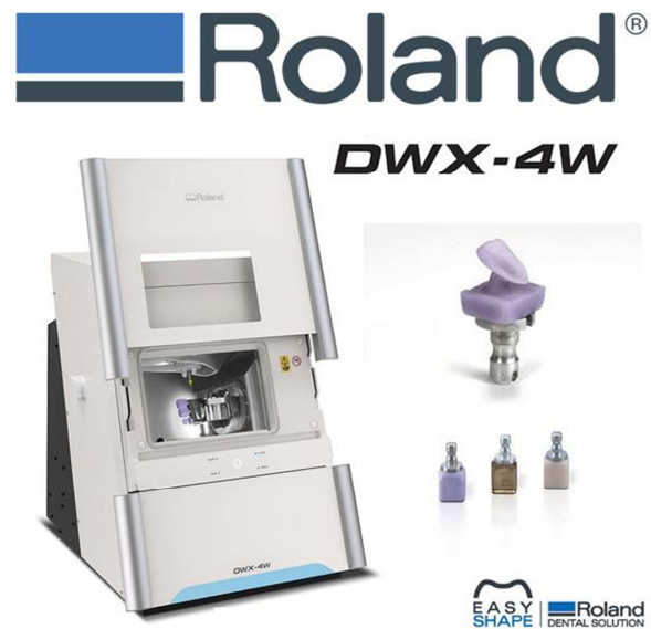
Figura 14. Fresadora de 4 ejes marca Roland, Modelo DWX -4W. Se puede observar un bloque de material fresado. Este tipo de fresadoras trabajan mecanizando un bloque de material con la ayuda de un líquido refrigerante que evita el calentamiento de la fresa. Las fresas que se utilizan pueden ser de diamante o carburo dependiendo el material a fresar.
