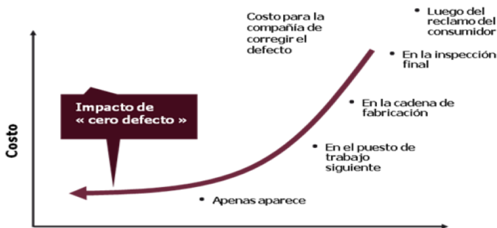
Figura 6: Relación entre Costos asociados a la etapa de aparición del defecto, fuente propia
