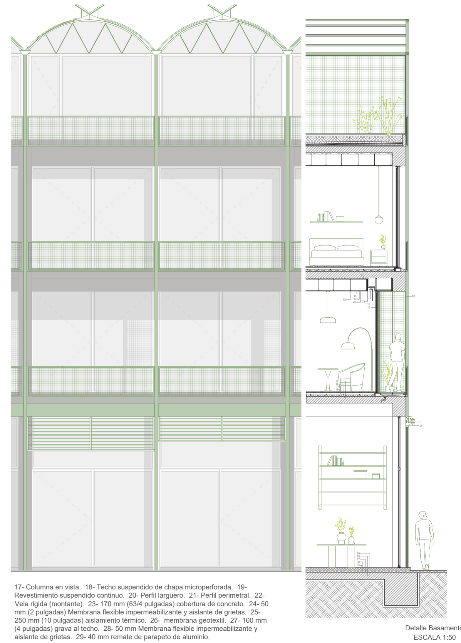
Imágen/es: Detalle constructivo
