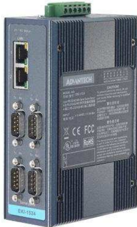
Ilustración 6: Conversor ADAMTECH EKI-1524-BE
