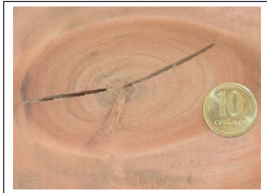
Nudo firme exhibiendo una grieta
