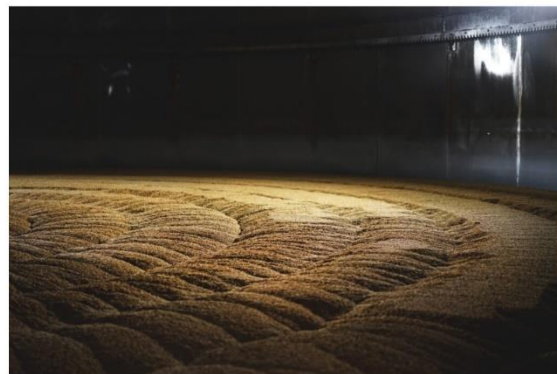
Un recipiente de germinación cargado que también es un horno.
