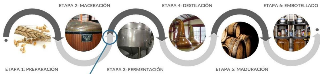
Ilustración 1 - Proceso simplificado de elaboración de Whisky
