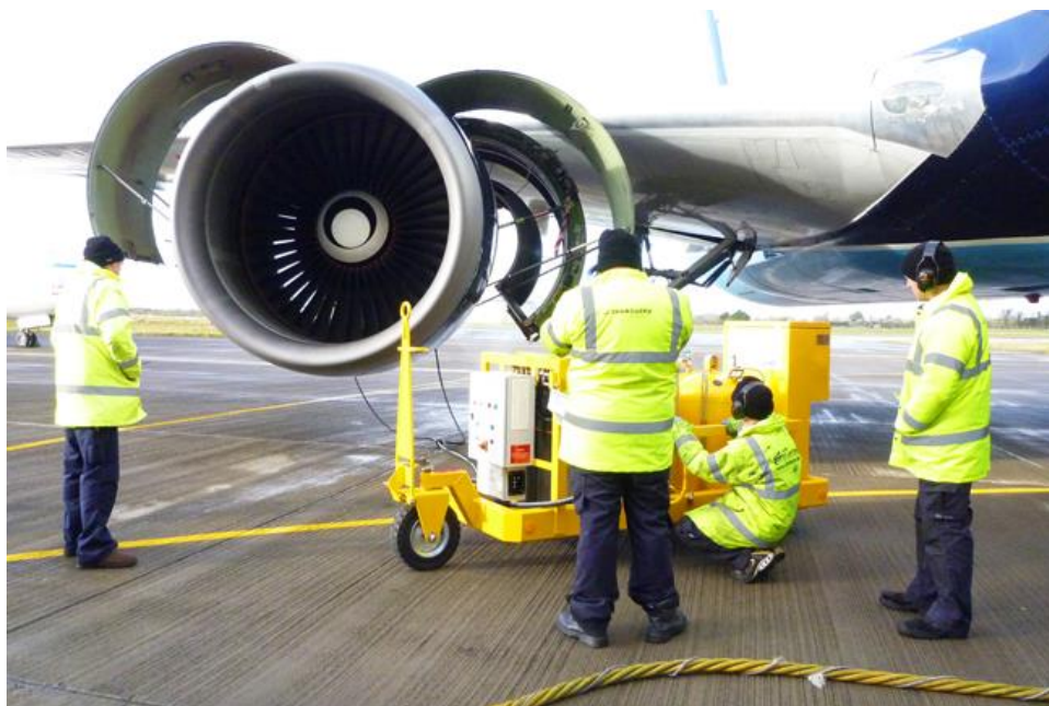
✚ Disposición típica de un equipo de lavado Juniper, nótese que no tienen colector de fluidos.
