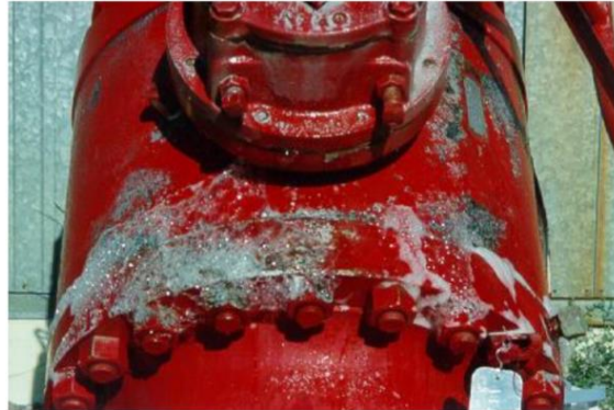
Figura 11 - Detección de fugas con burbujas de jabón (Fuente: Climate and Clean Air Coalition & Oil and Gas Methane Partnership, 2017)
