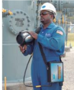
Figura 13 - Detector remoto de fugas láser (RMDL) (Fuente: EcoPetrol & Instituto Colombiano del Petróleo, 2014)
