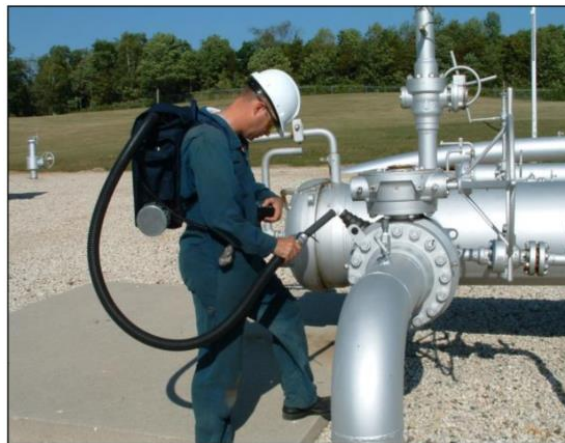
Figura 14 - Cuantificación con muestreador de alto flujo (Fuente: Climate and Clean Air Coalition & Oil and Gas Methane Partnership, 2017)
