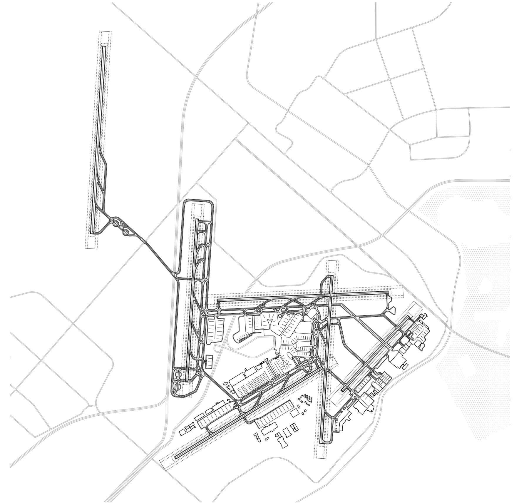
Planta aeroportuaria. Escala 1:45000. AMS/EHAI_Infraestructura aeroportuaria (sistema runways, sistema taxiways, sistema aprons), implantación
