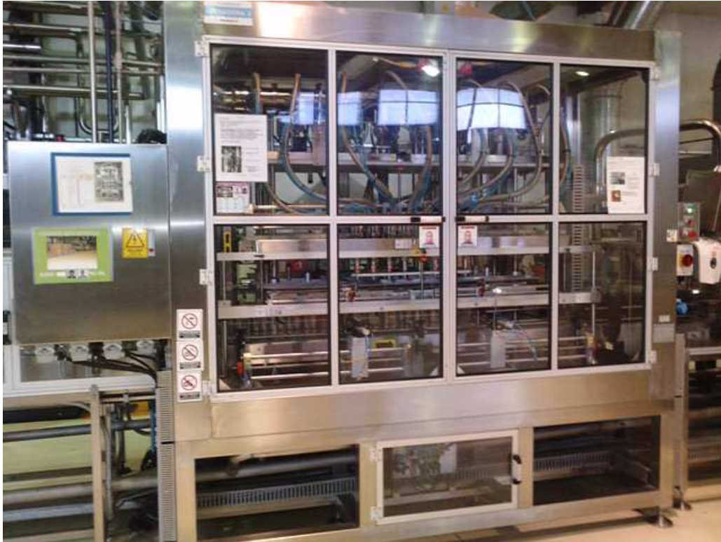
Línea de llenado de botellas de alta flexibilidad – tamaño de botellas desde 400ml hasta 6000 ml.
