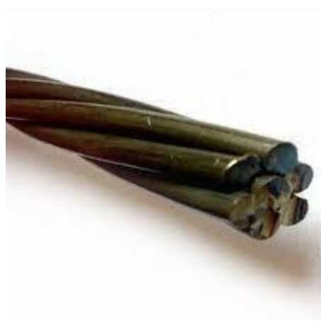
Figura 12 Cordón Pretensado compuesto por 6 alambres torzales y un alma
