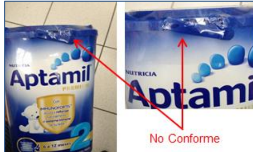
Figura 12: Producto defectuoso por clip dañado Fuente: Danone México, documentación interna (2013).
