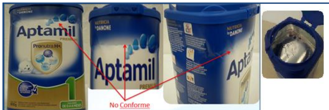
Figura 11: Producto defectuoso por abolladura
