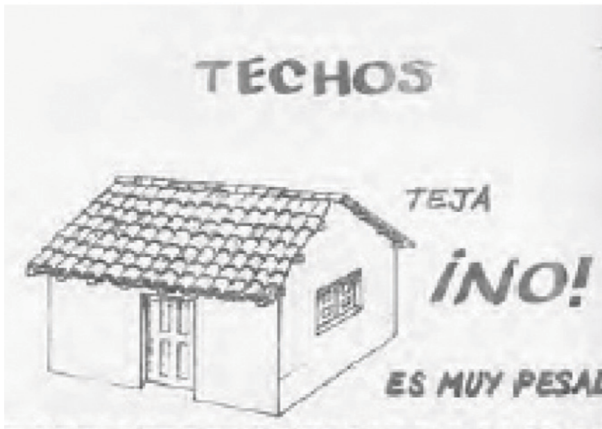
1. Casa para refugiados en India después del terremoto en 2001 por Shigeru Ban hecha con materiales locales como el bambú. (Ban, 2001) 2. Recomendaciones para reconstrucción después del terremoto en Guatemala en 1976 por Fred Cuny. El cartel indica reemplazar los techos pesados de teja con los que se había empezado a construir a partir de la colonización española (previo a este hecho se construían techos con caña y paja., una imposición cultural que agravó la vulnerabilidad de las casas. (The Sphere Project)
