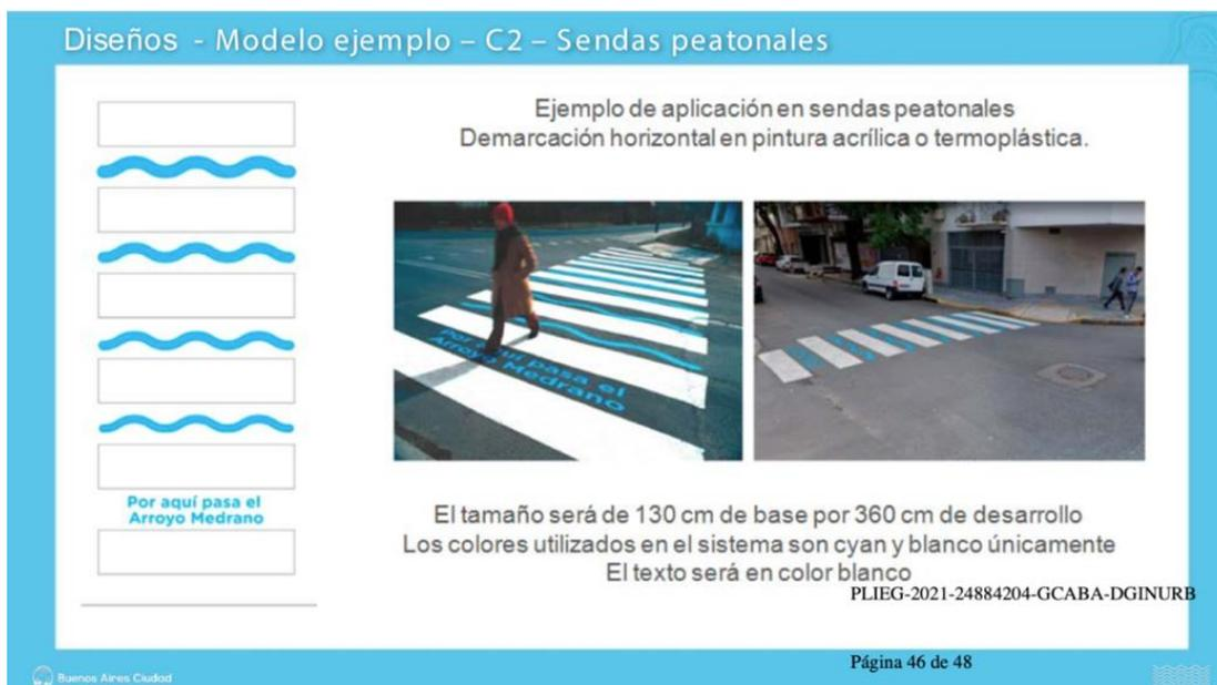
Fig. 31. Ejemplo de señalética en stencil sobre pavimento
