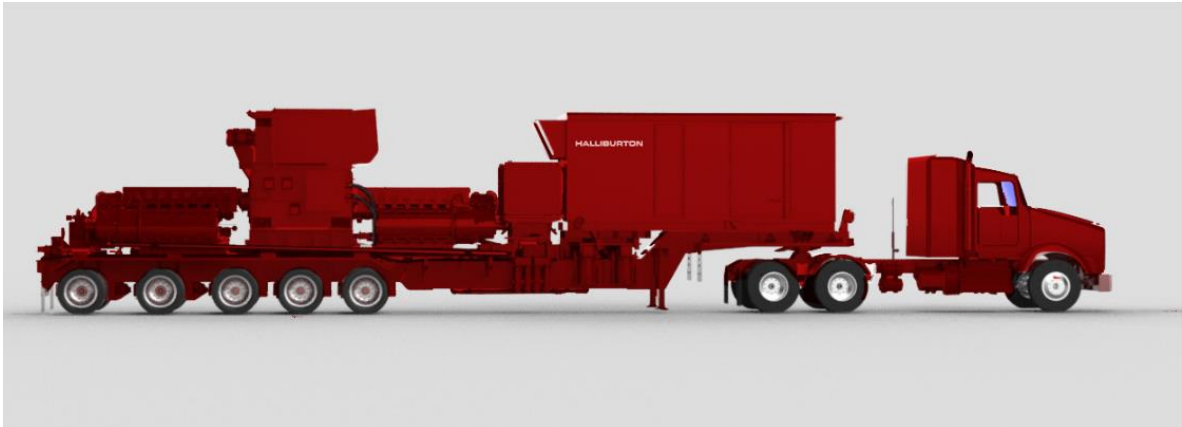
Figura 20: Fracturador con motor eléctrico que puede ser alimentado por motor recíprocante a gas natural o turbina.
