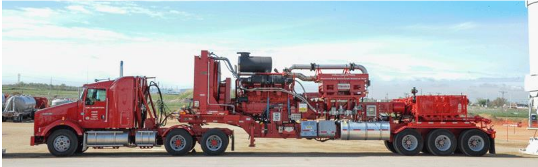
Figura 21: Fracturador con adaptación dual-fuel.
