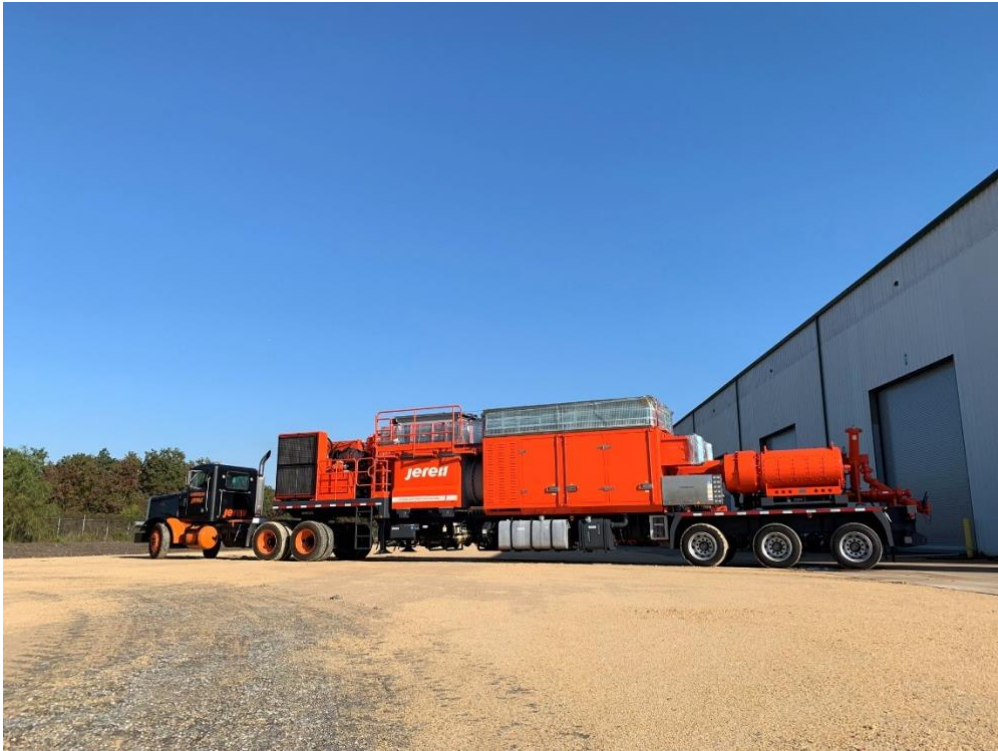
Figura 19: Fracturador con turbina de transmisión directa.
