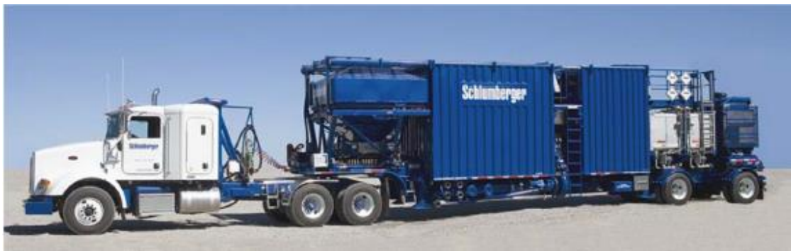
Figura 9: Unidad de Hidratación
