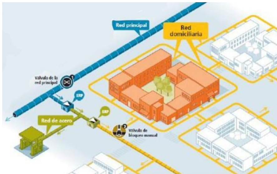
Figura 1. Esquema de una red de distribución de gas típica
