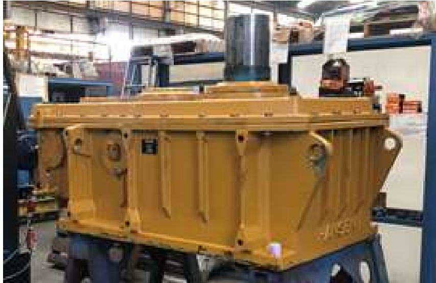
F. Caja Reductora de Velocidad Marca Hansen, de ejes paralelos, vista lateral.
