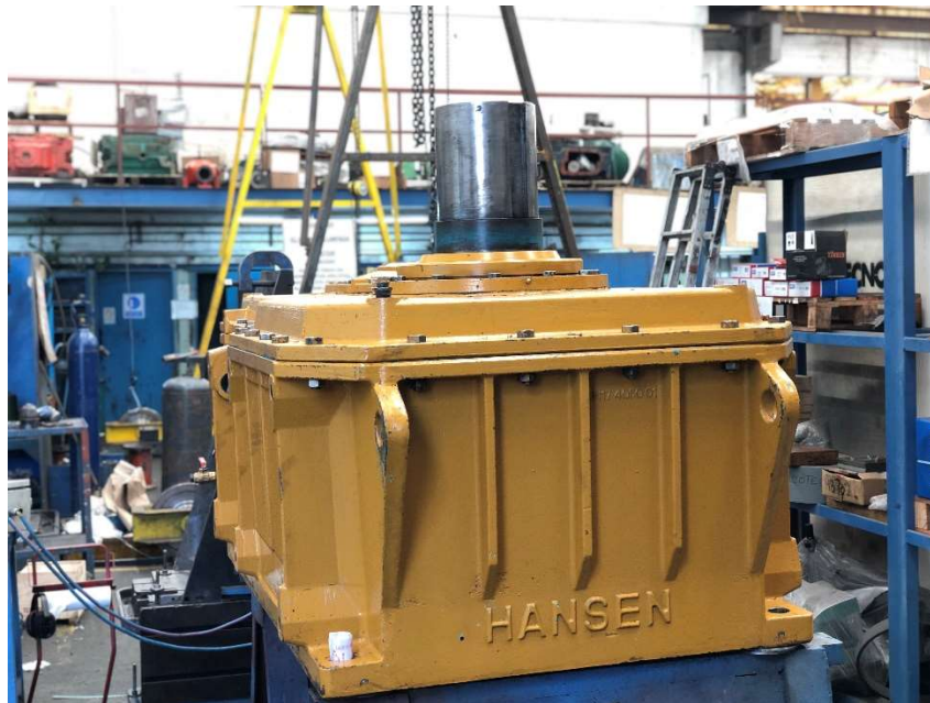
E. Caja Reductora de Velocidad Marca Hansen Cerrada, de ejes paralelos.
