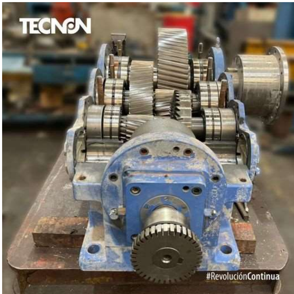
G. Caja Reductora de Velocidad Marca Tecnon (Acotec), de ejes ortogonales.
