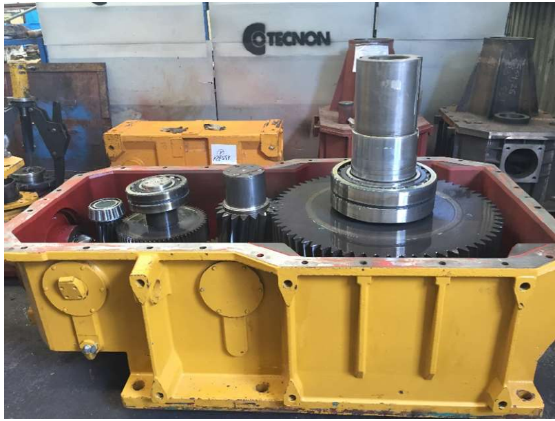
D. Caja Reductora de Velocidad Marca Hansen Abierta, de ejes paralelos.
