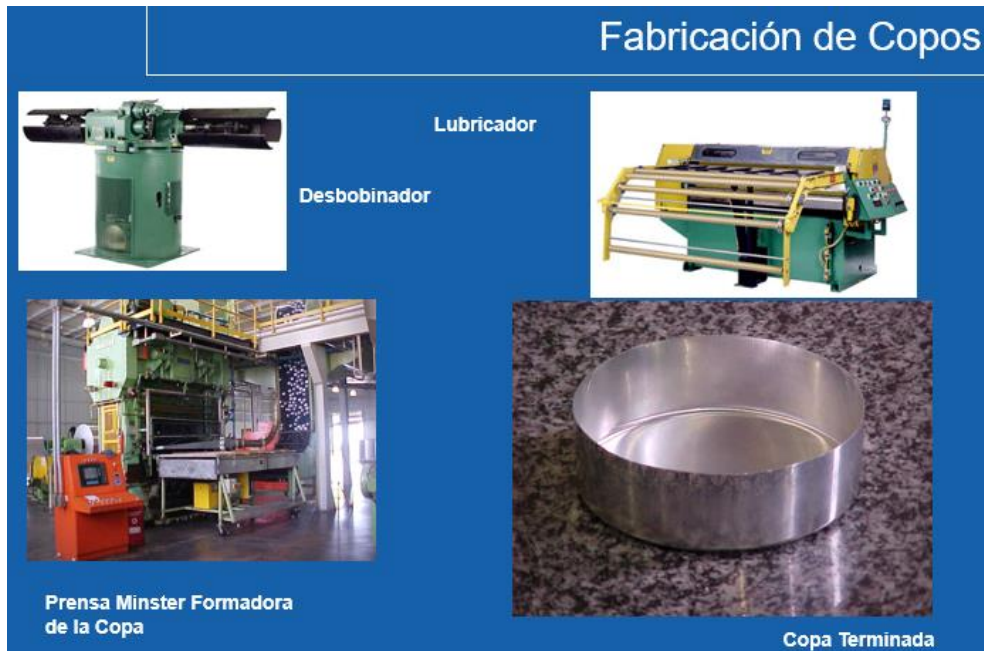
Figura 2 Proceso de estampado; Fuente: Ball corp.
