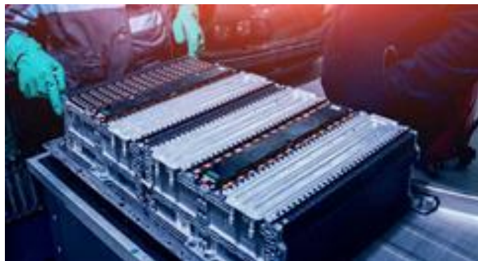
Figura 1. Batería de vehículo eléctrico
