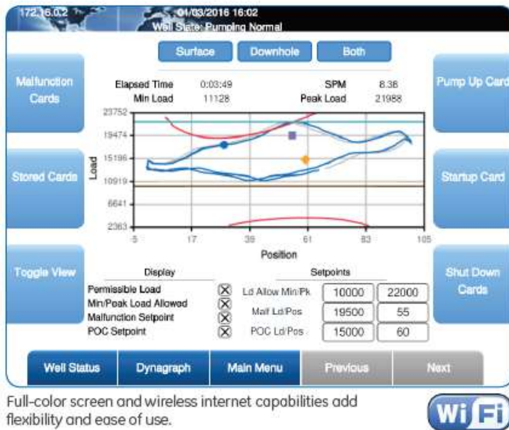
Figura 17 Carta dinamométrica en un Lufkin Well Manager mostrando datos como pico de carga. 31
