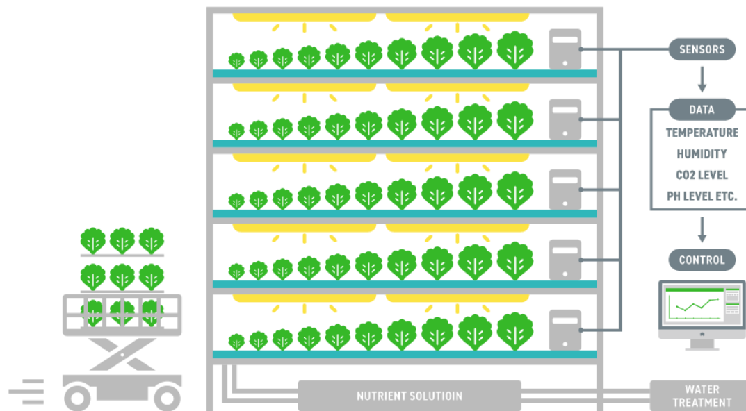
Figura 32: Esquema del sistema de producción completo.
