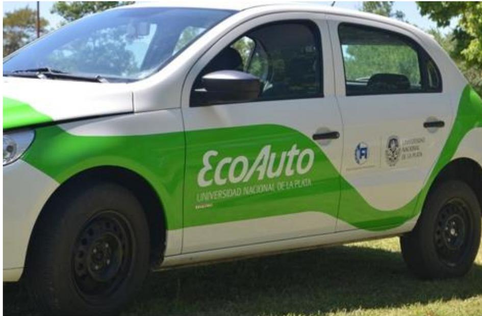
Se trata del VW Gol con un motor trifásico de 12 kilovatios, adaptado con materiales reciclados, que consume la mitad de energía que un aire acondicionado para recargarse, en un tiempo estimado de cinco horas. Y es el primer auto eléctrico desarrollado por una universidad latinoamericana.
