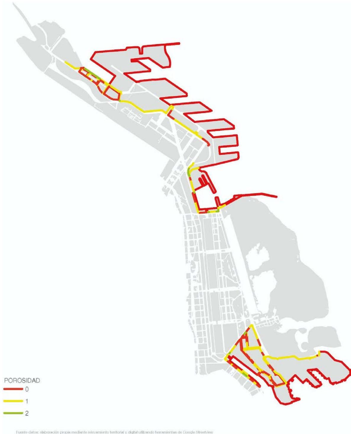
Figura 7.2.3.5 Niveles de Porosidad del contorno Continental y Fluvial. Siendo 0 ningún tipo de permeabilidad, 1 semipermeable y 2 permeable. Fuente: elaboración propia
