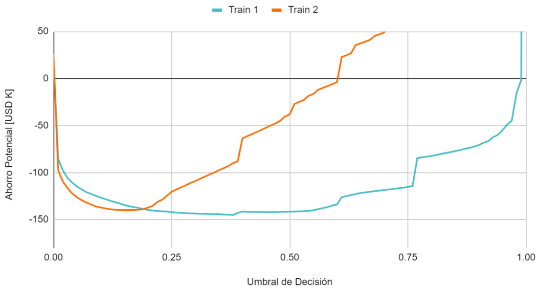
Figura 54: gráfico de la función de ahorro potencial en base al conjunto de test. El eje horizontal representa el umbral de decisión del modelo. El eje vertical presenta el ahorro potencial en miles de USD.
