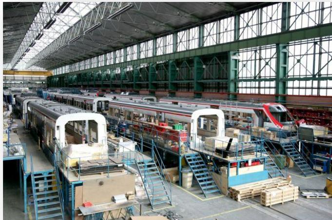
Una vez que el tren esta acoplado a la estación de trabajo, el trabajador debe desplazarse a lo largo, no es posible tener desplazamientos horizontales entre fosas ni pedir herramientas o insumos por debajo ni pasar por encima por normas de seguridad. Por ejemplo, el tren puede estar con tensión (corriente) y su pasan por debajo corren riesgo de vida.
